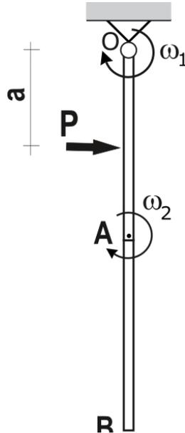
9.- El sistema de la figura se compone de dos varillas articuladas de masa  $m$  y longitud  $2a$ , dispuestas como puede verse en la figura. Calcular las velocidades angulares de ambas varillas tras recibir una percusión  $P$  como la de la figura adjunta. Calcular también las percusiones de ligadura que aparecen en el punto  $O$ .
