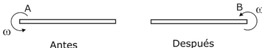
3.- Un disco de radio  $a$  y masa  $m$ , desliza con un movimiento de traslación rectilínea de velocidad  $V$  sobre una recta. En un momento dado, el disco entra en una zona de rozamiento infinito, pasando a rodar sin deslizar sobre la recta anterior. Calcular la velocidad angular  $\omega'$  que el disco adquiere, al entrar en la zona con rozamiento.
